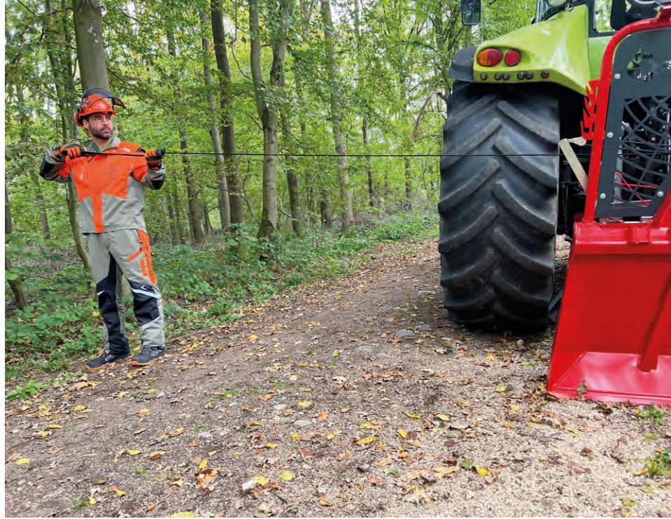
SW 5500P Betätigungseil für Kupplung (Seileinzug)
