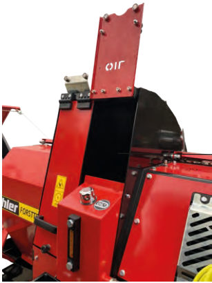
OL 4800 HZ - Ölbehälter und Aufbewahrungsfach
