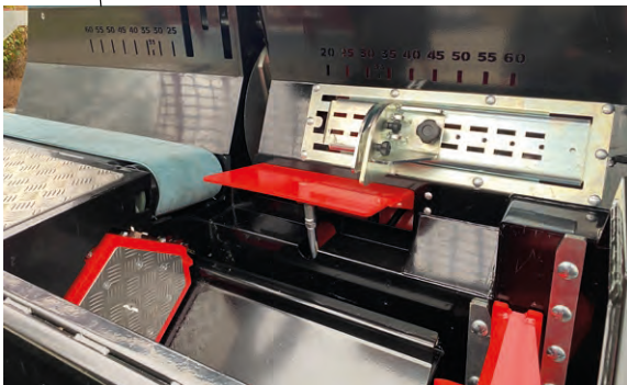
OL 4800 HZ - Schnittlängeneinstellung und Auswurfklappe
