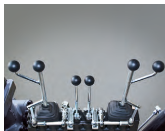
6-fach Steuerung mechanisch
