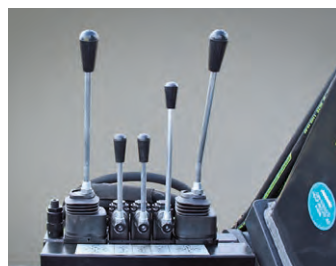
Kreuzhebelsteuerung 7-fach mechanisch
