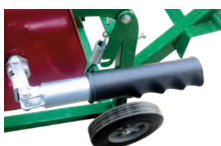
Not-Aus Schaltung für Zapfwelle
