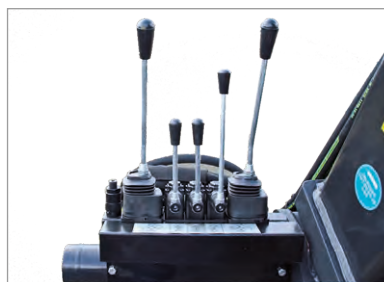
Kreuzhebelsteuerung 7-fach mechanisch
