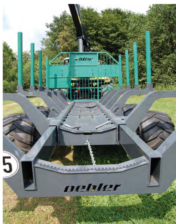
Stabiler und ausziehbarer Doppelrohrrahmen
