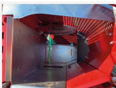
Niederhalter: auch für Rundholz geeignet
