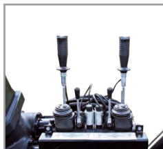
Kreuzhebelsteuerung 6-fach mechanisch 2-fach elektrisch
